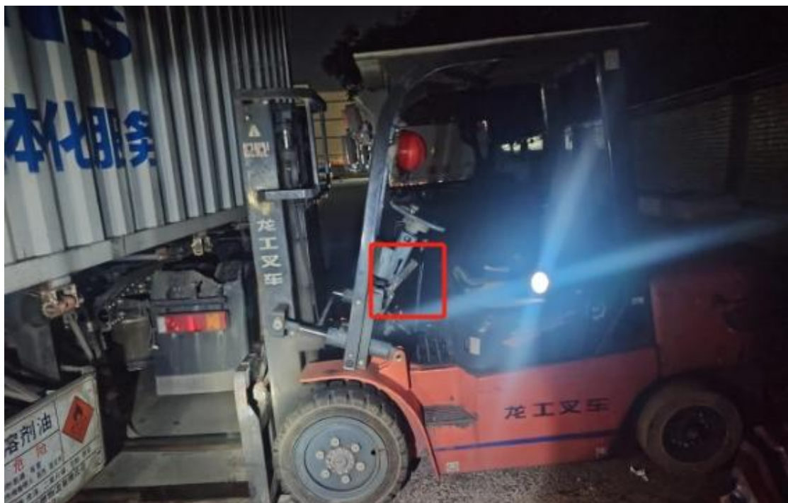
图 2 驻车制动操纵手柄处于制动位置
