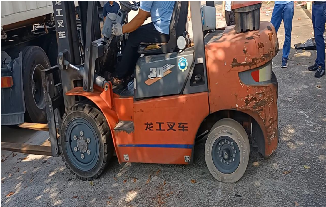
图 7 涉事叉车驻车制动性能试验
