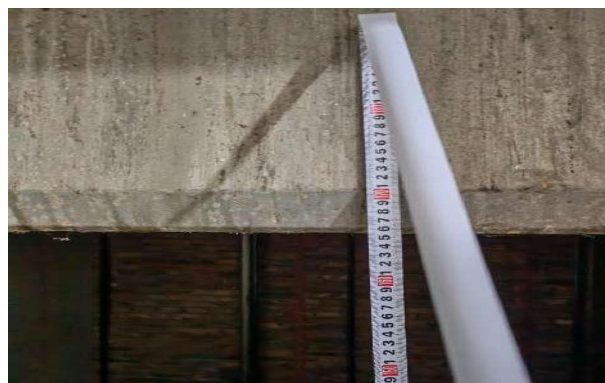
图 15、16 轿厢护角板距离 12 楼层门地坎高度
