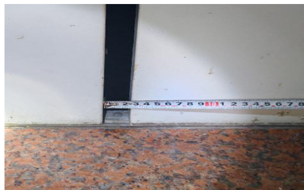
图 2 12 楼层门底部门扇之间间隙
