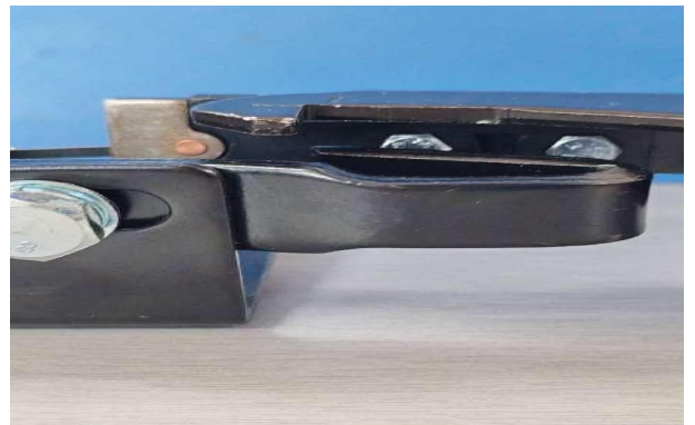
图 26 撬棍作用力致主门锁锁舌横向侧移
