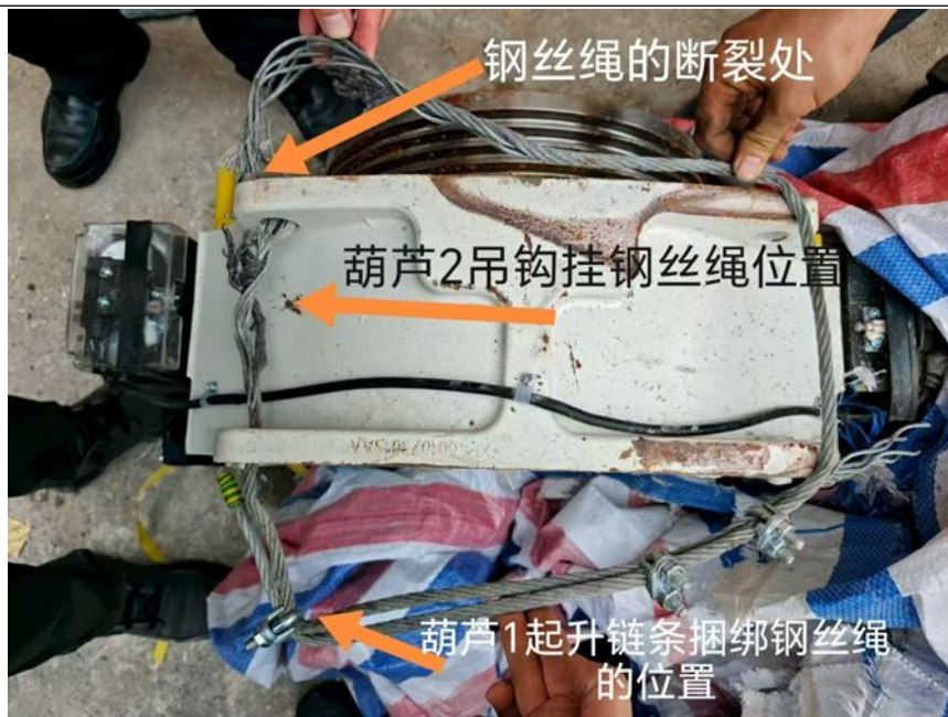
图 19 模拟钢丝绳与曳引机的捆绑状态
