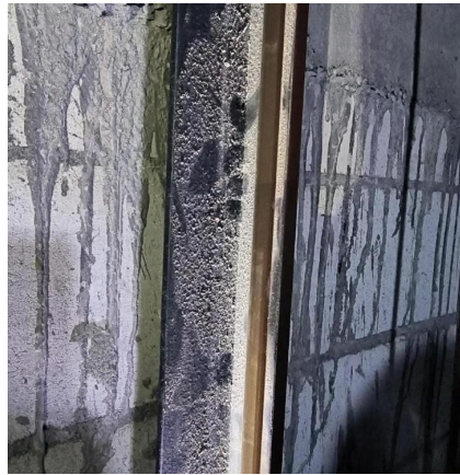
图 19 15 层左侧轿厢导轨上的抓痕
